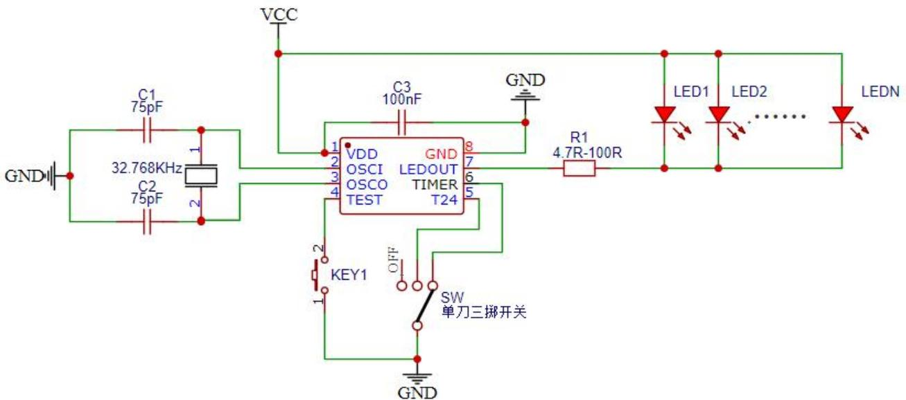
**注：**本控制 IC 可以外接晶振实现定时功能，外接晶振频率为 32.768KHZ。
